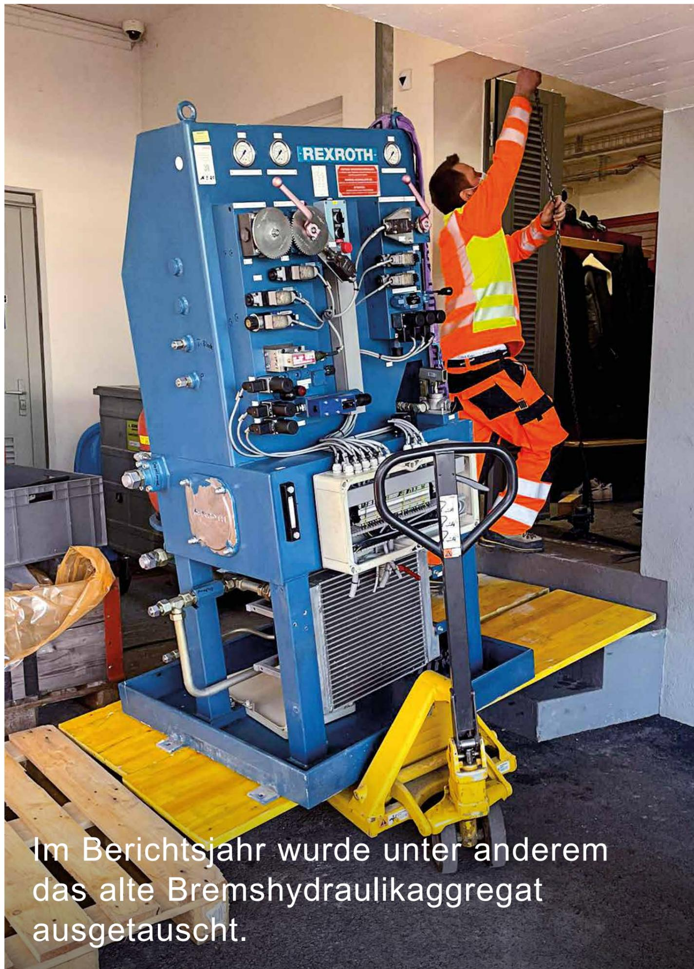
Im Berichtsjahr wurde unter anderem das alte Bremshydraulikaggregat ausgetauscht.
